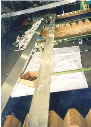
*Abziehen und Reinigen der Lamellen in Arbeitsräumen!*
